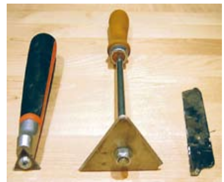
Bild: Exempel på olika profilerkarpor. Från vänster hårdmetallskrapa med färdig profil, modifierad trekantskrapa och tillfilat bandsågsblad
