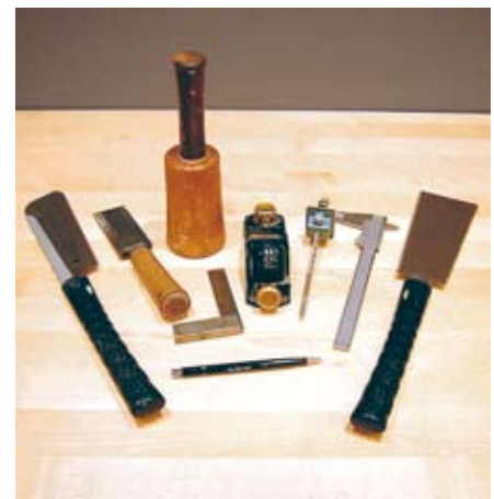
Lämpliga verktyg för trälagningar: från vänster japansk ryggsåg, 40 mm stämjärn, träklubba, vinkelhake, stöthyvel, strykmått, skjutmått, japansk kombisåg (kap och klyvfunktion) samt 0,5 mm stiftpenna.
